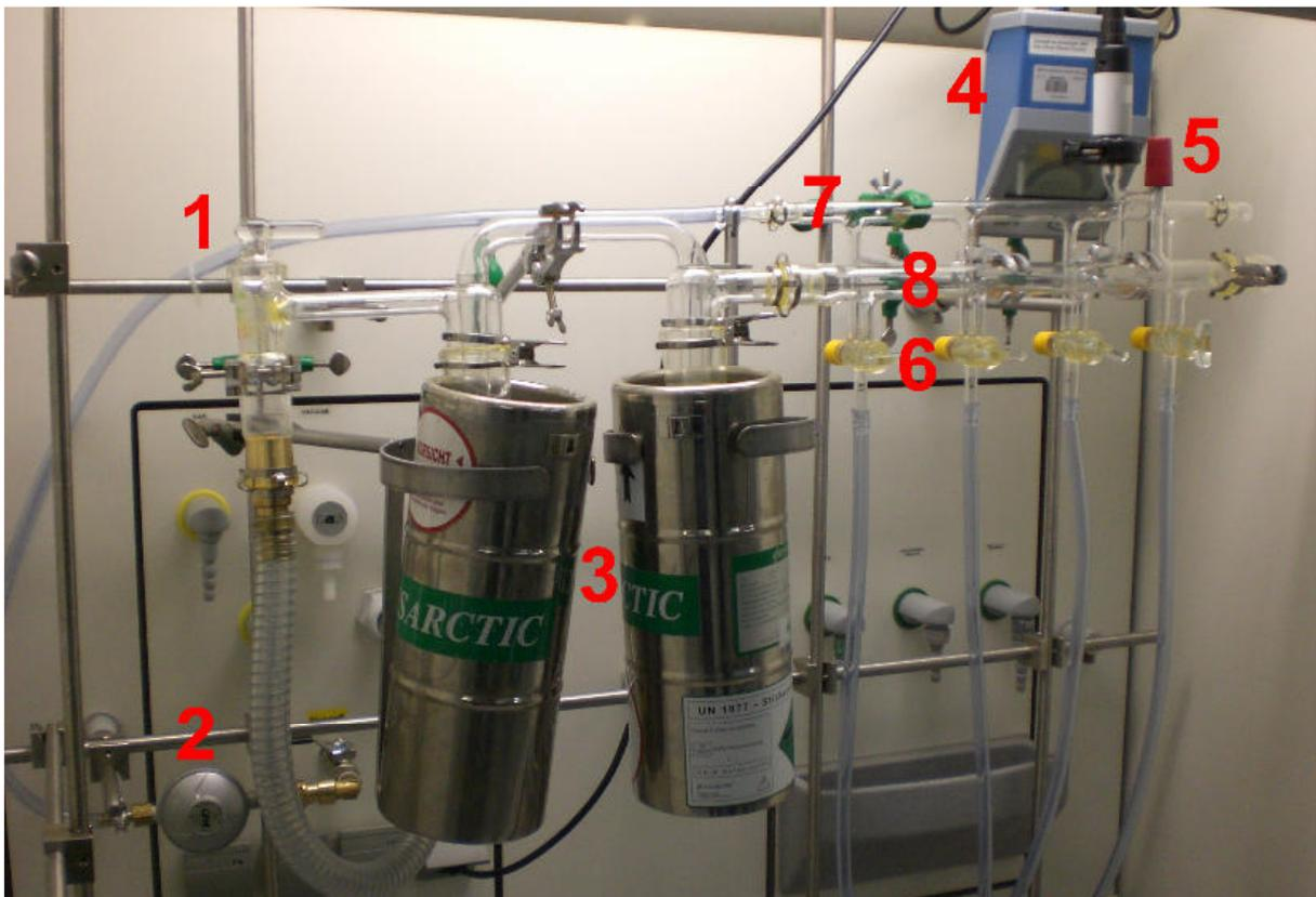
Standard-Vakuumanlage im AFP-Saal. 1: Stickstoffleitung, 2: N<sub>2</sub>-Reduzierventil 50 mbar, 3: Kühlfallen mit Dewars, 4: digitale Druckanzeige, 5: Absperrhahn zum Drucksensor, 6: Wechselhähne für Vakuum und N<sub>2</sub>, 7: N<sub>2</sub>-Ast, 8: Vakuum-Ast.
